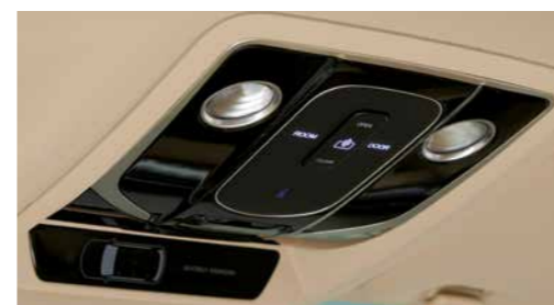
Consolle superiore con luce rossa di avviso cintura di sicurezza
