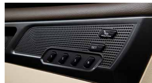
Sistema di controllo della memoria di posizione per il sedile del conducente
